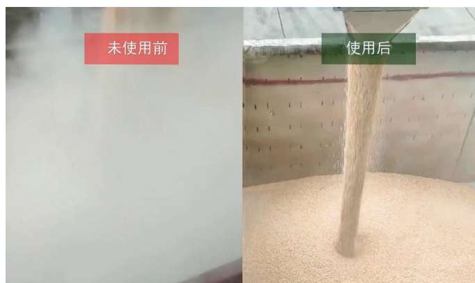
侧壁发放抑尘斗使用效果对比图
