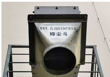
侧壁发放抑尘斗外观
